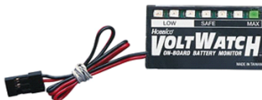
Figura 6.3: Exemplo de um VoltWatch para baterias NiCd ou NiMH.
